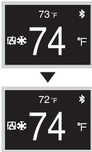
Presione **-** y **+** y el punto medio cambiará. Cuando la unidad interior está apagada, incluso si se presiona **-** o **+** o la pantalla de inicio, el punto medio no cambia.
