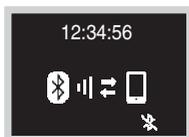
Si la conexión es exitosa, momentáneamente se mostrará la pantalla de la figura de la izquierda y luego cambiará a la pantalla de comparación numérica.
