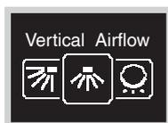
Presione **-** o **+** para ajustar la dirección del flujo de aire vertical y presione **OK** para confirmar.
