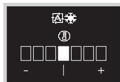
En la pantalla de escala, el punto de ajuste se puede cambiar en el rango de  $\pm 3^{\circ}\text{C}/^{\circ}\text{F}$  de la temperatura de referencia.
