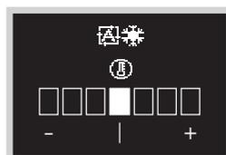
Dans l'écran d'échelle, le point de consigne peut être modifié dans la plage de  $\pm 3^{\circ}\text{C}/^{\circ}\text{F}$  par rapport à la température de référence.
