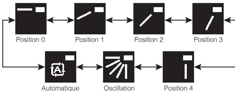
Réglage de la direction du flux d'air (gauche/droite)
