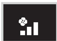
Le réglage des vitesses du ventilateur variera en fonction du modèle de l'unité intérieure. Appuyez sur ou pour ajuster la vitesse du ventilateur et appuyez sur pour confirmer.
