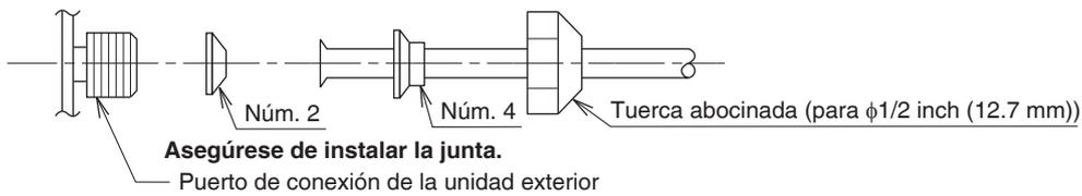
(3) Conexión de un tubo de  $\phi 3/8$  inch (9.5 mm) a un puerto de conexión de tubo de gas  $\phi 5/8$  inch (15.9 mm):
