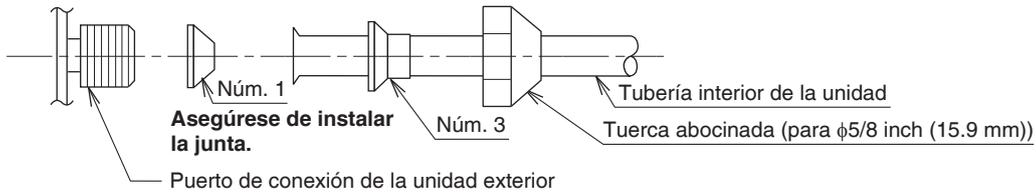
(2) Conexión de un tubo de  $\phi 3/8$  inch (9.5 mm) a un puerto de conexión de tubo de gas  $\phi 1/2$  inch (12.7 mm):
