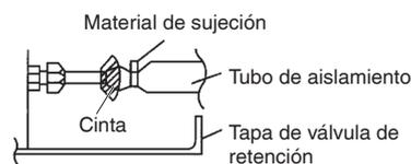
Utilice cinta adhesiva o material aislante en todas las conexiones para evitar que entre aire entre el tubo de cobre y el tubo de aislamiento. Asegúrese de hacer esto si la unidad exterior está instalada a una altura mayor que la de cualquiera de las unidades interiores conectadas a ella.
