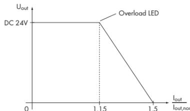
Abb. 4: Ausgangskennlinie
