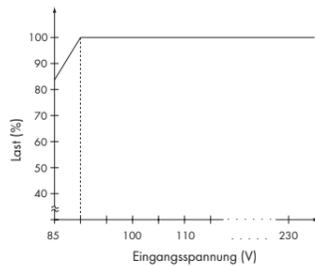
Abb. 6: Eingangsspannungs-Last-Kennlinie
