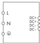
Abb. 1: Primär getaktete Gleichstromversorgung 787-712
