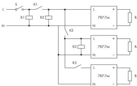
Abb. 3: Zeitversetztes Zuschalten von Netzgeräten
